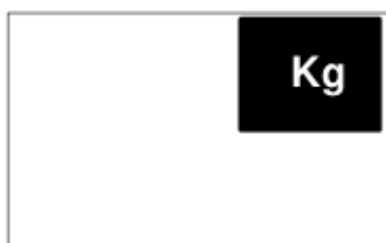
Mauvais placement de la charge
